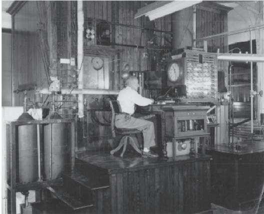
图 2 Atwater 测热计<sup>[1]</sup>
